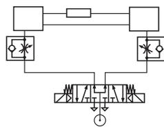
Diese Steuerung reduziert die Toleranzen beim Anfahren der Zwischenpositionen. Durch die Rückschlagventile wird der Bremsweg verkürzt und die Laststeifigkeit verbessert.
