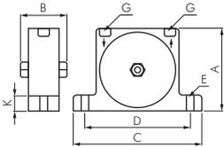
**Werkstoffe:** Gehäuse: Aluminium eloxiert, Kugel und Laufbahn: Stahl gehärtet, Deckel: Edelstahl AISI 303
