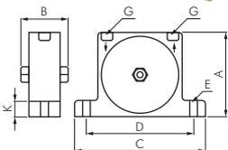
**Werkstoffe:** Gehäuse: Aluminium eloxiert, Rolle und Laufbahn: Stahl gehärtet, Deckel: Edelstahl AISI 303
