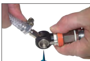
Kupplung ausschwenken - Kupplung schließt und entlüftet
